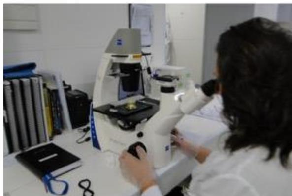
**Fotos 3.2.1-3 e 3.2.1-4. Amostra na câmara de sedimentação de Utermöhl e contagem do fitoplâncton em microscópio invertido.**
