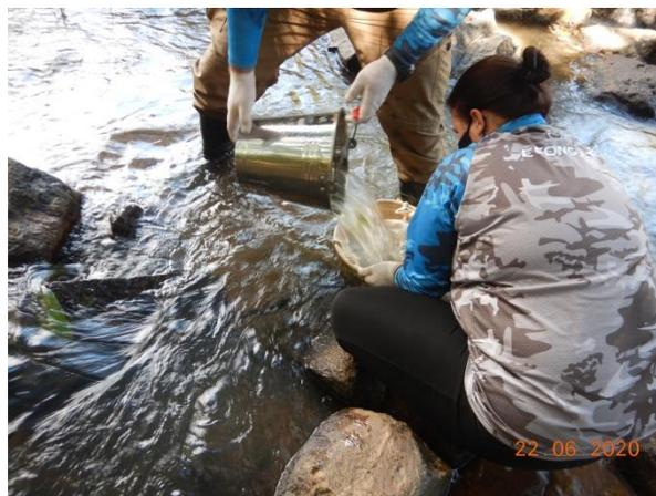
**Fotos 3.2.3-1 e 3.2.4-2. Coleta de sedimentos para análises de invertebrados bentônicos com amostrador Petersen e lavagem de sedimento em campo.**
