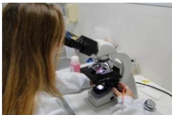
**Fotos 3.2.2-3 e 3.2.2-4. Amostra na câmara de Sedgewick-Rafter preparada para análise em e identificação do zooplâncton em microscópio óptico.**
